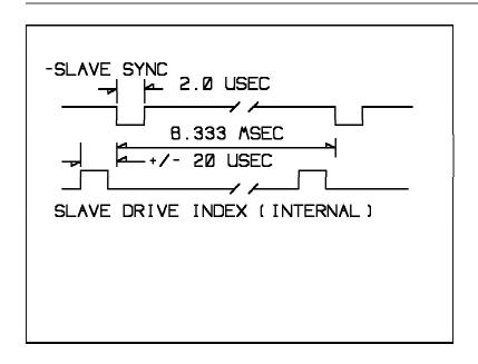
Figure 37. Slave-Sync to Slave-Index Timing
