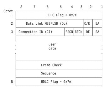
Figure 24. Frame-Relay Frame Format
