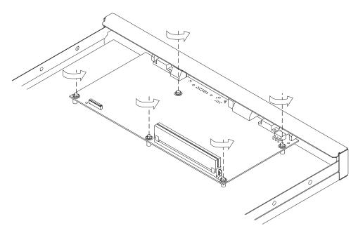
Figure 4-6. Non-ISDN System Board (12x Models)
