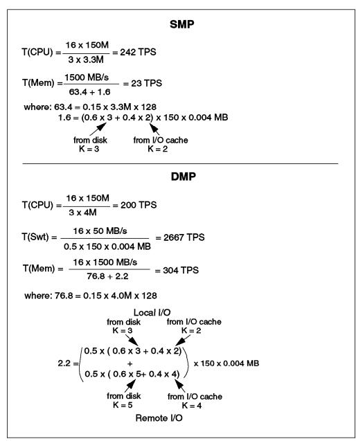
Figure 66. SMP vs. DMP Throughputs
