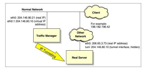
Figure 27. IP tunneling
