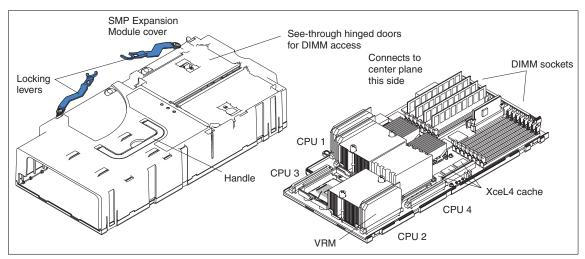
Figure 1-10 SMP Expansion Module
