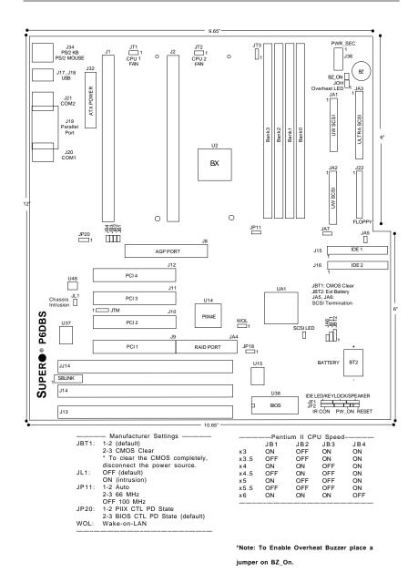
Figure 1-2. SUPER P6DBS Motherboard Layout
